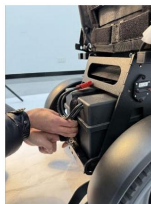
EEMALDAGE ALUMINE AKUKATE, HOIDES SELLE ÜLEMISEST ÄÄREST JA VAJUTA ALLA
