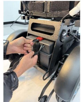
ÜHENDA PISTIKUGA TOITEALLIKAS JA RATASTOOL
