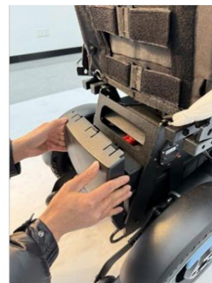
EEMALDAGE ALUMINE AKUKATE, HOIDES SELLE ÜLEMISEST ÄÄREST JA VAJUTA ALLA
