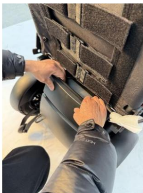
EEMALDAGE ÜLEMINE AKUKATE, HOIDES SELLE ÜLEMISEST ÄÄREST JA VAJUTA ALLA
