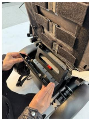
EEMALDAGE ÜLEMINE AKUKATE, HOIDES SELLE ÜLEMISEST ÄÄREST JA VAJUTA ALLA
