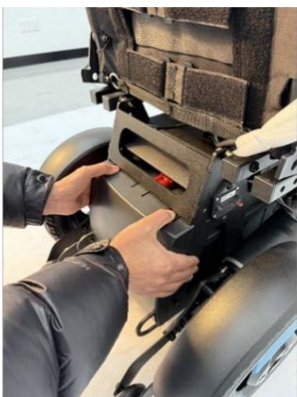
EEMALDAGE ALUMINE AKUKATE, HOIDES SELLE ÜLEMISEST ÄÄREST JA VAJUTA ALLA
